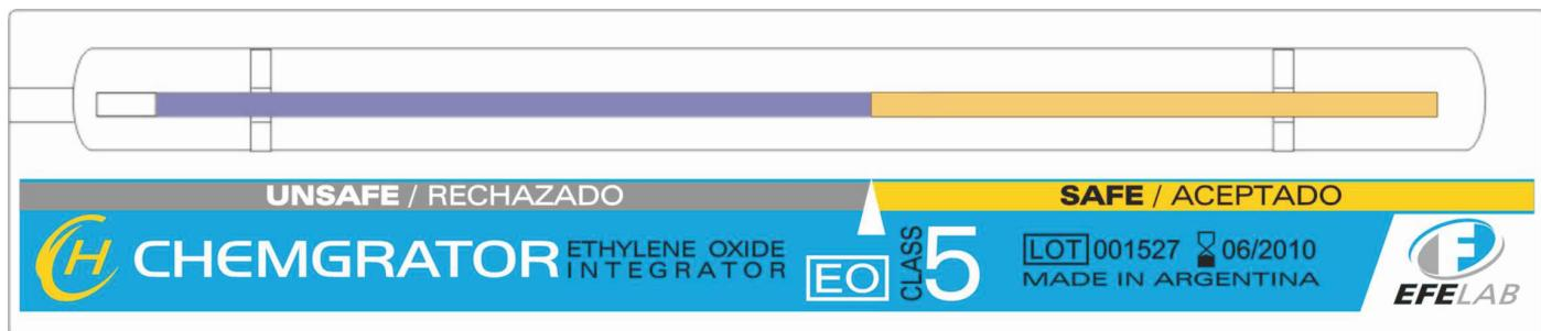
Los indicadores CHEMGRATOR están especialmente diseñados para integrar los efectos de tiempo, temperatura y concentración de Oxido de Etileno en los procesos de esterilización. El color amarillo del indicador se torna azul en presencia de estas tres condiciones y avanza progresivamente brindando evidencia visual inmediata si las condiciones necesarias de esterilización han alcanzadas durante el ciclo.
